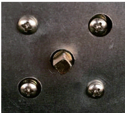
用扳手顺时针拧冷凝水流量加大，提升散热效果
